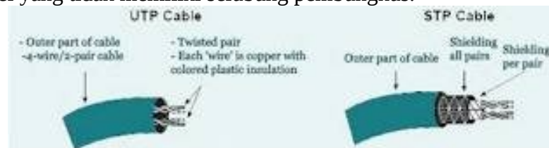
Gambar 1.3 Kabel UTP dan Kabel STP
